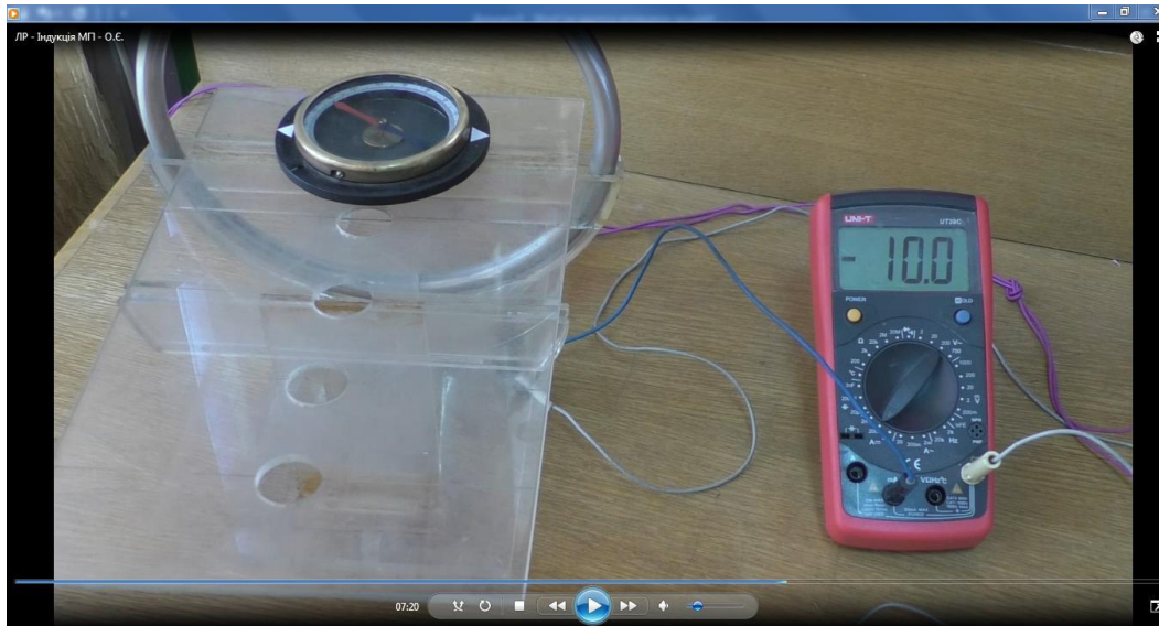
Фото 2. Фрагмент відео лабораторної роботи (зняття показників на тангенс-гальванометрі при зворотньому протіканні струму величиною 10 мА)
