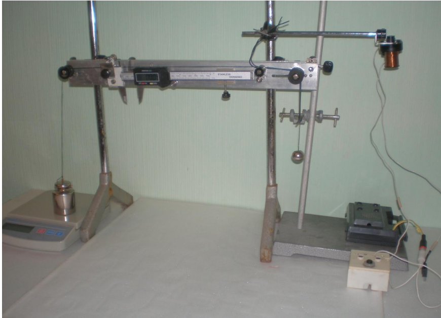
Рис. 3. Експериментальна установка з визначення добротності математичного маятника
